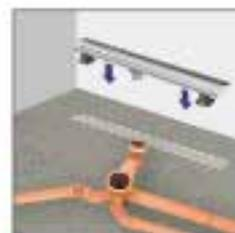
**4.** Conecta el caño de salida de la base del desagüe con el caño de desagote de la ducha. Recomendamos sellar con silicona neutra para evitar filtraciones.
