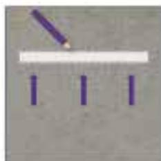
**3.** Ubica la canaleta donde harás la instalación y marca el contorno del desagüe. La profundidad mínima de la canaleta deberá ser de, al menos, 100 mm considerando la conexión a la red de desagote de la vivienda.
