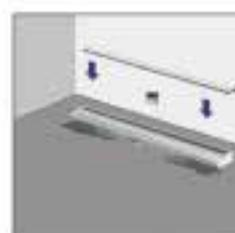
**8.** Extiende la mezcla de concreto hasta llegar al borde superior del desagüe considerando el espesor del revestimiento a utilizar y dejando una inclinación como mínimo de 2% por metro lineal, en dirección a donde se instalará. Si lo deseas, instala una membrana impermeabilizante siguiendo las instrucciones del fabricante.
