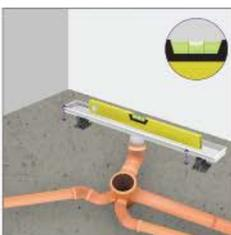
**5.** Utiliza la cinta bi-faz de las patas regulables para fijarlas al desagüe. Presenta el desagüe, regula la altura y verifica un buen apoyo en el suelo guiándote de la regla nivel.
