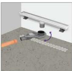
**4.2.** Conecta el caño de salida del desagüe en el cuello de goma del sifón ATRIM. Rótalo hasta la posición de instalación y conéctalo con la cañería de desagote. La altura del desagüe con el sifón incluido varía entre 10 y 12 cm.
