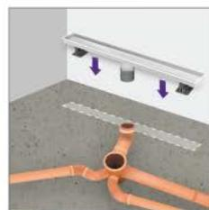
**4.** Conecta el caño de salida de la base del desagüe con el caño de desagote de la ducha; se recomienda sellar con silicona neutra para evitar filtraciones. El desagüe se entrega con el adaptador de 40 mm insertado.
